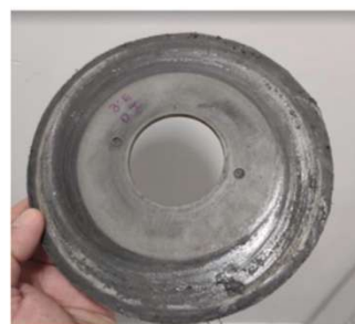
Figura 82 – Arruela desgastada Pouca espessura de material para proteção.
