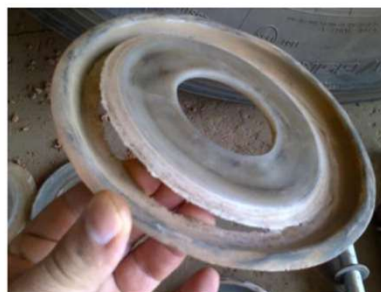
Figura 82 – Arruela desgastada Pouca espessura de material para proteção.
