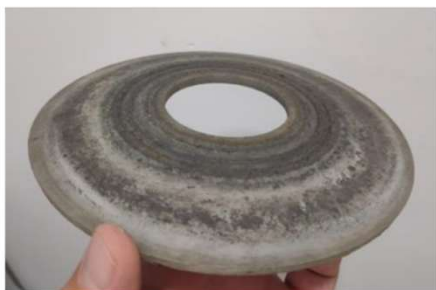
Figura 81 – Arruela côncava Ainda com espessura de material para proteção.
