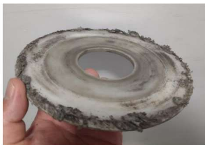
Figura 80 – Arruela com rebarbas Ainda com espessura de material para proteção.
