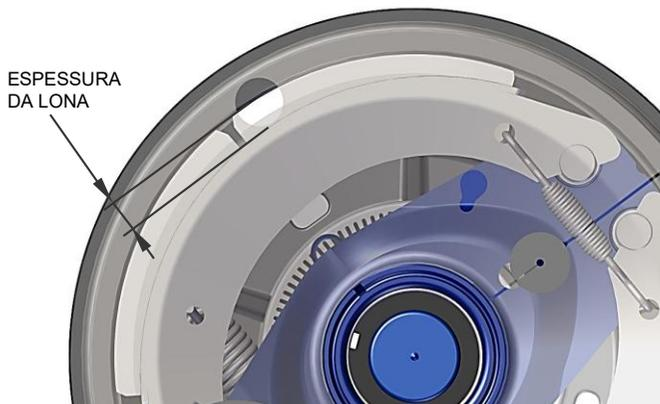
Figura 100 – Espessura das lonas de freio
