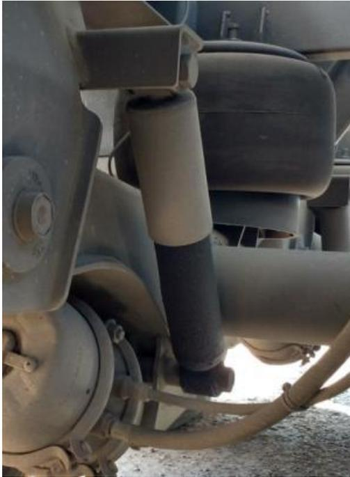
Figura 68 – Exemplo de vazamento
